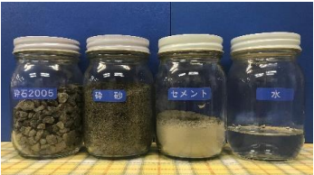
コンクリート練り混ぜキット 所定量を計量してあるので水を加えて混ぜるだけ
