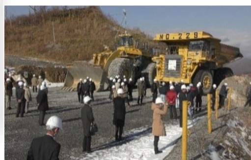
バケット容量20m³のWA1200と100t積みダンプ
