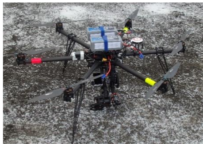
24Vバッテリー2ヶで 秒速6mで飛びます!
