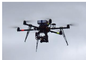
24Vバッテリー2ヶで 秒速6mで飛びます!
