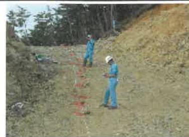
これはハンマー打撃による振動の伝播速度を計測することで地山の緻密さや風化度合いを調べるもので、当社（安山岩）の採掘対象岩石における弹性波速度の目安は  $3500 \text{ m/sec}$  程度と推定されます。伝播速度が速いほど新鮮で緻密な岩石が賦存していることになります。
